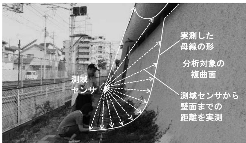
実測の様子。三脚の上に固定した測域センサの位置を原点とし、分析対象の複曲面までの距離を放射状に270°の範囲を0.25°毎に測定する。
