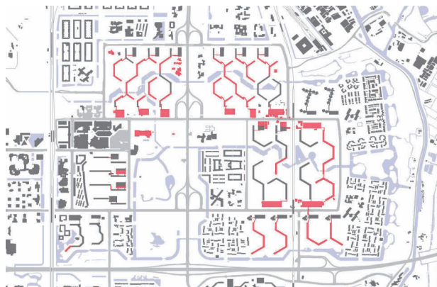
図 24 1992年のベルマミア団地配置図(赤は解体)
