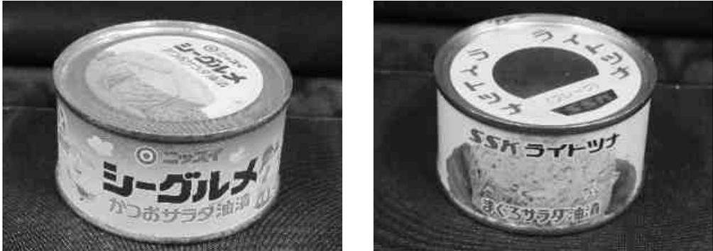
図10 試料の外観（古い缶詰〔左：膨張有、右：膨張無〕、両方ともに2020年2月撮影）
