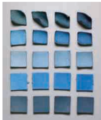
写真5 アルカリ性浴下における合成藍染色を用いて染色した革 n=20
