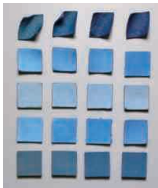
写真4 中性浴下における合成藍を用いて染色した革 n=20
