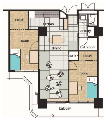
図4 19号棟 207号室改修後
