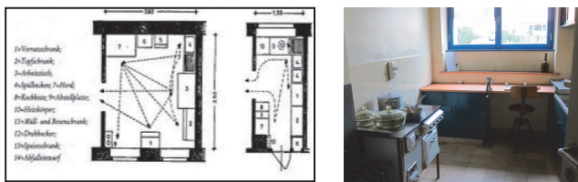
図17 フランクフルター・キュッヘ 左：ヴォーンキュッヘ（左）との動線比較、右：内部写真
